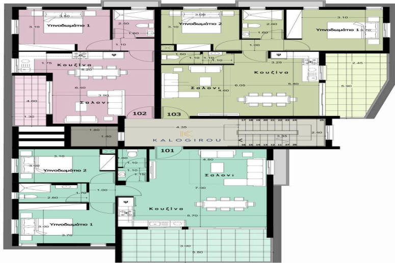
ΚΑΤΟΨΗ 1ΟΥ ΟΡΟΦΟΥ
